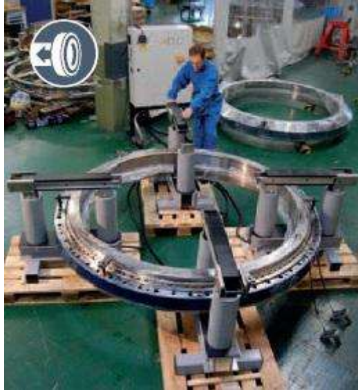
Figura 2 - aquecedor indutivo multinúcleo em rolamento de giro de grande porte.
