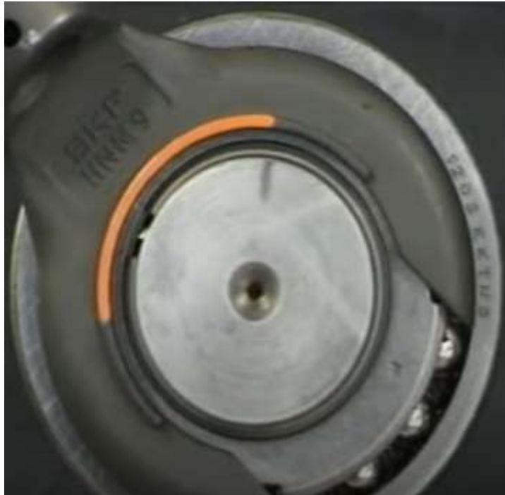
Figura 4 - ajuste de porca de fixação com chave de gancho.
