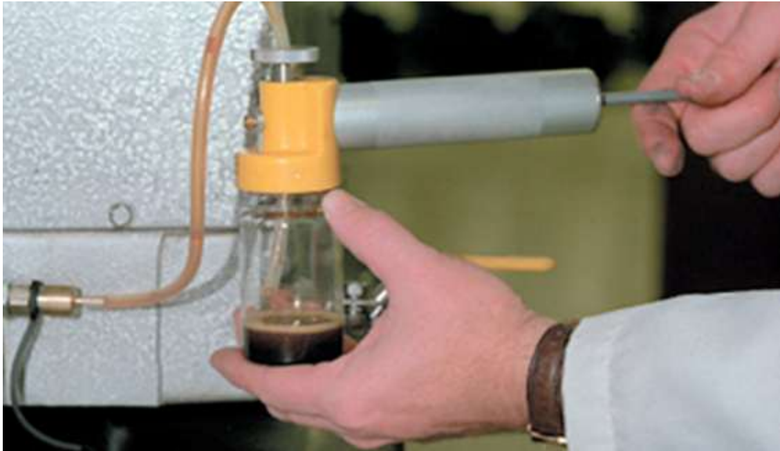
Retirada de amostra de óleo lubrificante.
