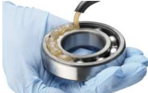
Aplicação de graxa por pistola em rolamento de esferas sem vedação.
