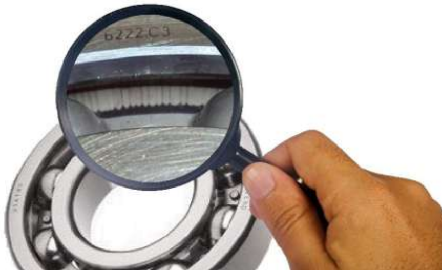
Inspeção visual em rolamento.
