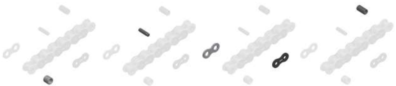
Rolo, pino, talas e bucha de uma corrente industrial.
